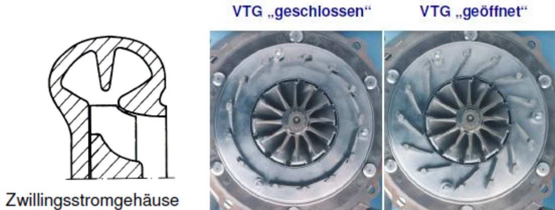
Abbildung 4.7: Ansicht der VTG in offener und geschlossener Schaufelposition
