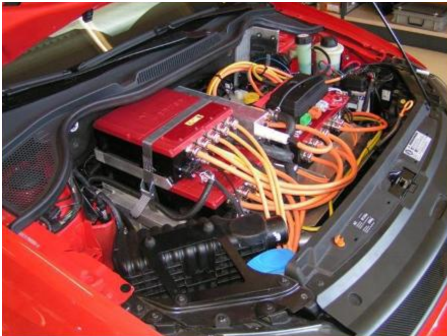
Abbildung 5.7.2 Motorraum mit Range Extender und Leistungselektronik in einem VW Polo
